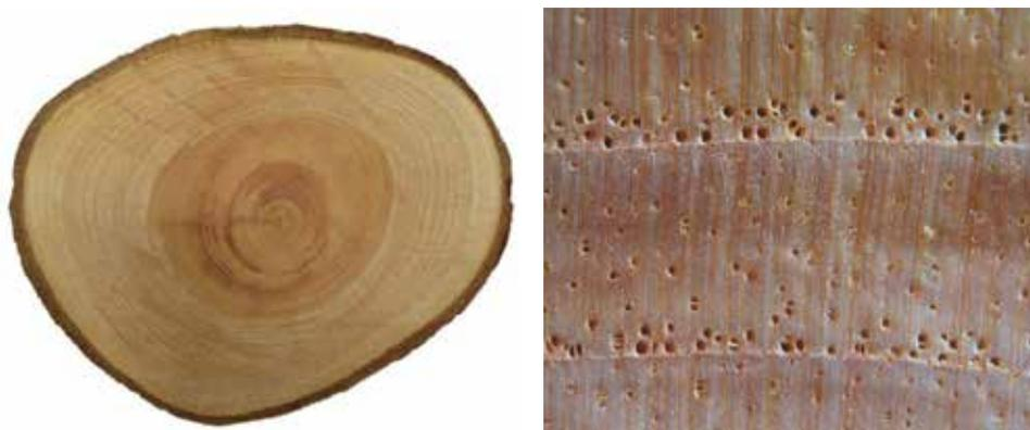
● Rodaja y vista macroscópica de sección transversal de *Cedrela montana*
