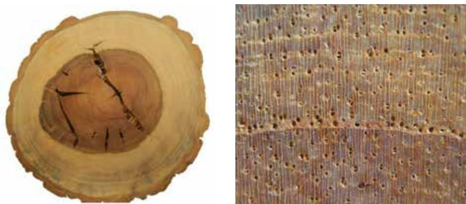
● Rodaja y vista macroscópica de sección transversal de *Cedrela fissilis*
