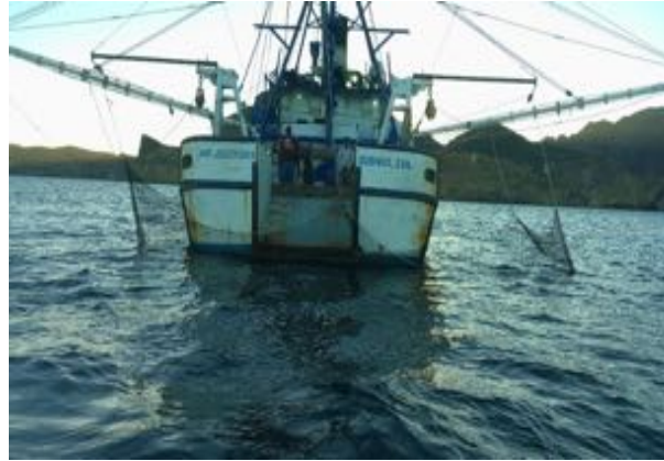
Figura 22. Detalle del arreglo del BIP XI y el bolso cúbico para determinar el TS de totoabas.
