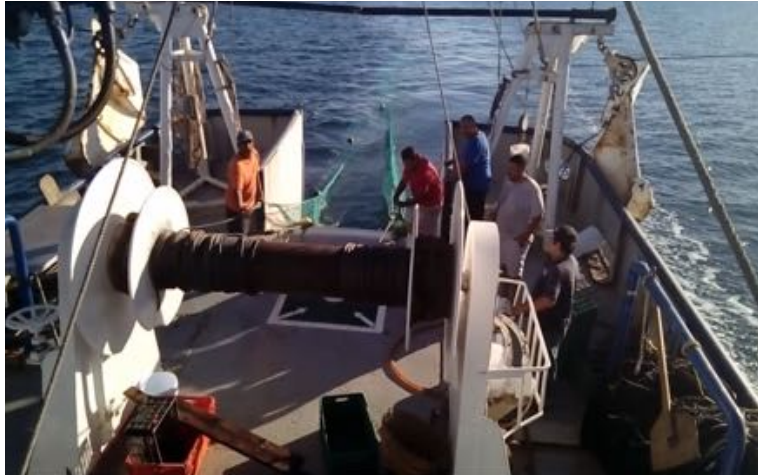
Figura 9. Pruebas realizadas para medir el desempeño de la red de arrastre de media agua modificada para capturar totoaba. El crucero se realizó en noviembre de 2016 a bordo del BIP XI, embarcación propiedad del INAPESCA.
