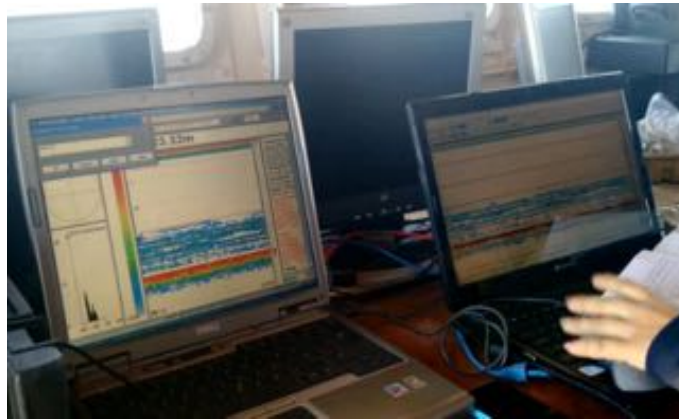
Figura 26. Detecciones del eco de totoabas.
