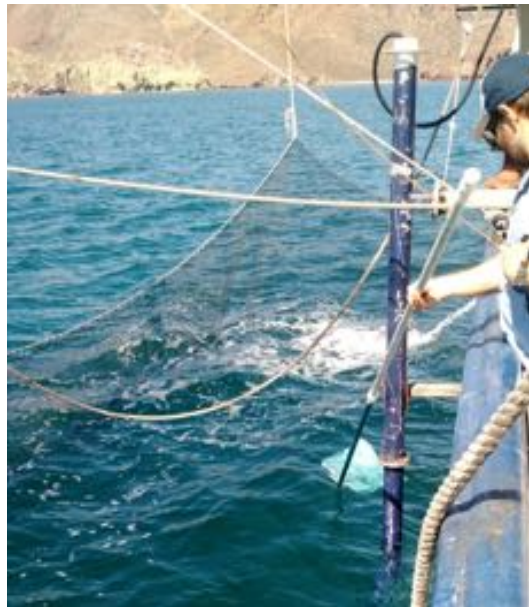
Figura 25. Colocación de juveniles de totoaba dentro del bolso de red para determinar su TS.
