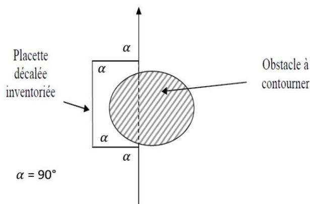
Figure 5 : Technique de contournement des obstacles
